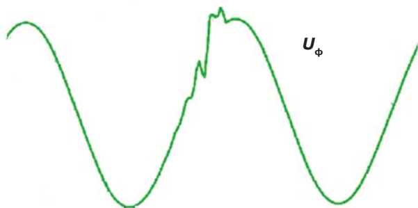
Рис. 3. Отражение импульса на фазе кабеля, содержащего обнаруженный дефект
